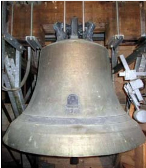
Glocke 1 „Friedensglocke – Bruder Klaus“ mit Ton f', gegossen 1976, Gewicht 1000 kg, Durchmesser 120 cm
