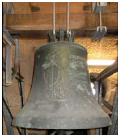
Glocke 3 „Marienglocke“ mit Ton b', gegossen 1950, Gewicht 428 kg, Durchmesser 88,3 cm
