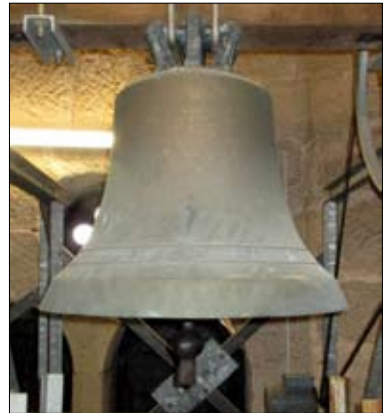
Glocke 4 „Josefsglocke“ mit Ton c', gegossen 1975, Gewicht 280 kg, Durchmesser 79,8 cm
